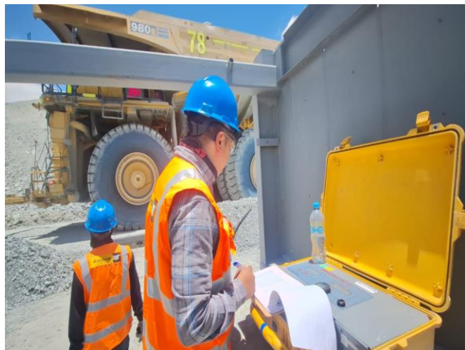
Figura 06. Pesaje de Camiones con balanzas para calibración y validación de las cargas con el sistema Argus.
